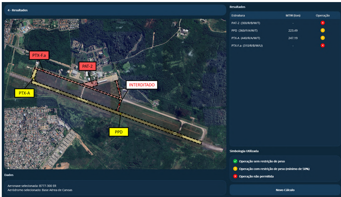
FIGURA 5.10 – Resultado do FastACR para o Cenário 2 — Boeing 777-300ER na Base Aérea de Canoas (SBCO).
