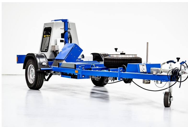
FIGURA 1.2 – Imagem ilustrativa de um Falling Weight Deflectometer (FWD)
