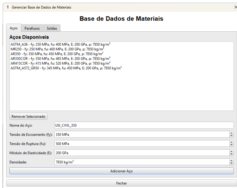
FIGURA 4.19 – Tela mostrando a adição do aço USI CIVIL 350 na base de dados do STCAD
