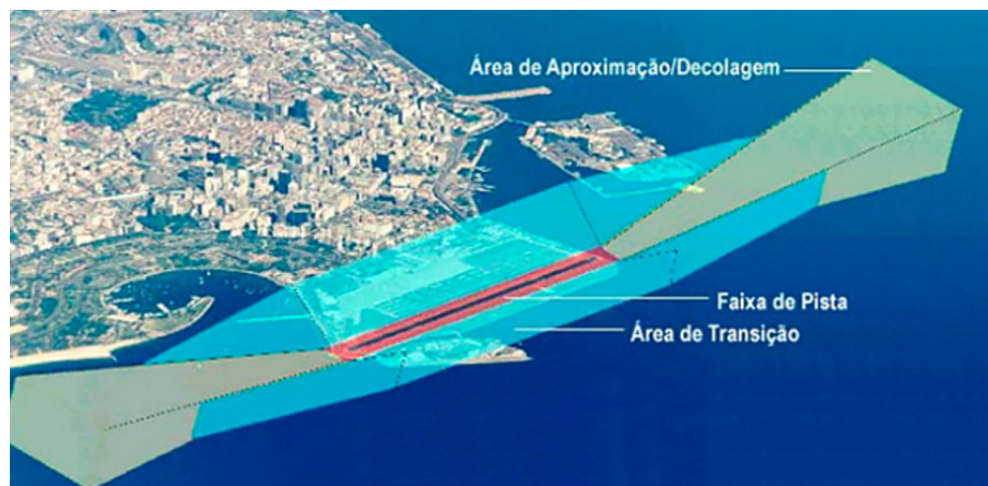
FIGURA 2.6 – Diagrama do Plano Básico de Zona de Proteção de Aeródromo segundo a ICA 11- 408 aplicadas ao aeroporto Santos Dumont no Rio de Janeiro
