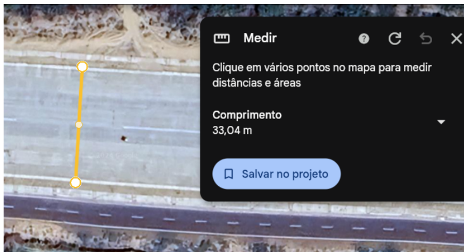
FIGURA 4.3 – Medição da largura do trecho para pouso em rodovia nacional indiana NH 925A
