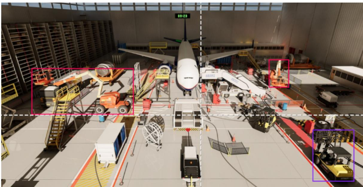
FIGURA 3.6 – Exibição das imagens anotadas, com as classificações de guindastes e empilhadeiras, na plataforma *Roboflow*
