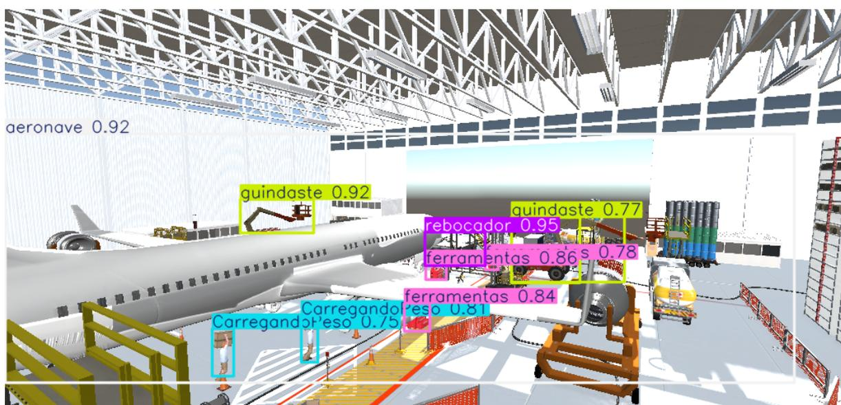
FIGURA 4.47 – Resultado de treinamento no *Google Colab*, usando o YOLOv8.
