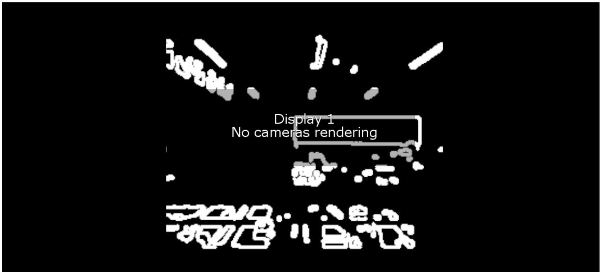
FIGURA 4.11 – Aplicação do algoritmo identificador de bordas inicial, sem tratamento de imagem.
