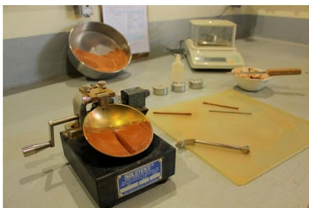
FIGURA 3.3 – Exemplo da execução de um ensaio de limites. Fonte: (ENGENHARIA, 2024a).
