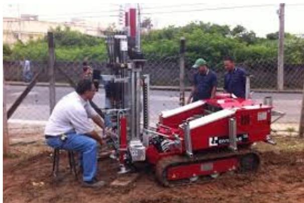
FIGURA 3.2 – Exemplo da execução de uma sondagem CPT. Fonte: (SOLO, 2024).
