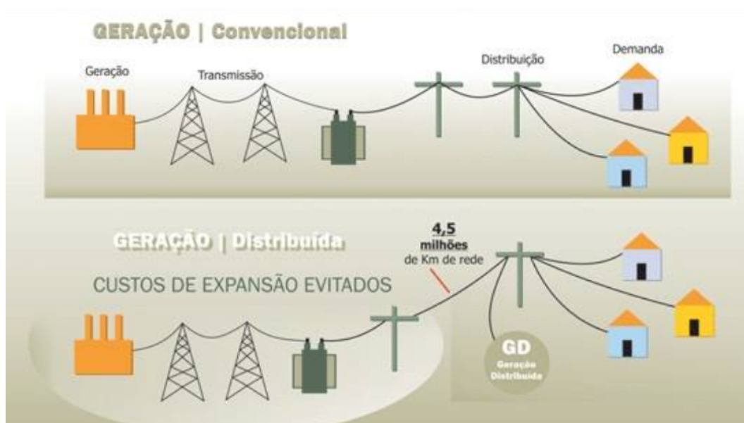
FIGURA 2.6 – Esquema de comparação entre a geração de energia convencional e a geração distribuída
