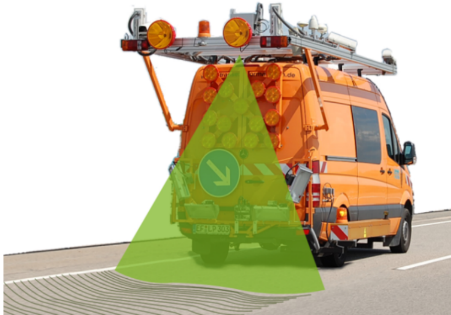
FIGURA 3.1 – Sistema de Mapeamento móvel S.T.I.E.R. Adaptado de (STRICKER et al. , 2019).
