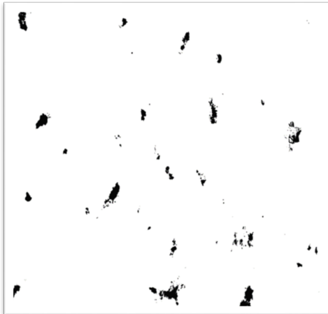
Figura 27. Imagem de parte de uma gota da água após a floculação usando a dosagem de 100 ppm obtida com o microscópio
