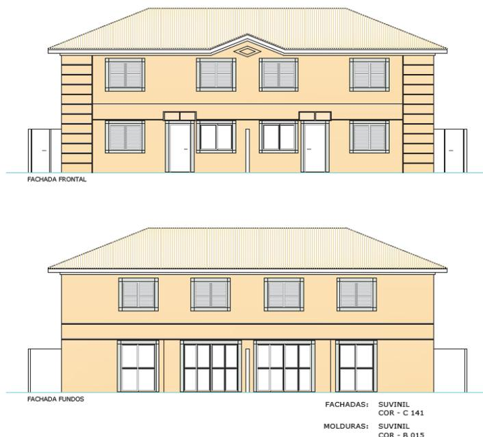
Figura 3.3 – Vistas Frontais Projeto Arquitetônico – (Construtora Sérgio Porto Engenharia)
