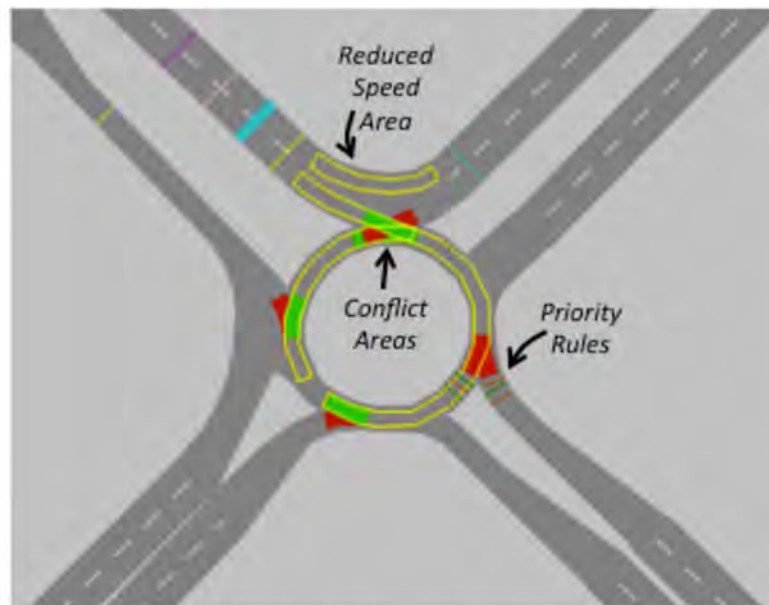
Figura 11 – Rotatória com detalhes dos Reduced Speed Areas , Conflicts Areas e Priority Rules
