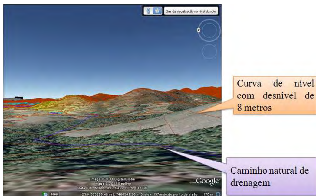
Figura 4.12: Visualização 3D das curvas de níveis e do caminho natural obtidos. Datum: WGS-84; Projeção: UTM Zona 23 e Norte Geográfico indicado pela letra “N” no canto superior direito.
