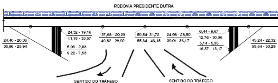
Figura 5 - Posicionamento Preciso dos ensaios - Viaduto 2 - Sentido SP/RJ
