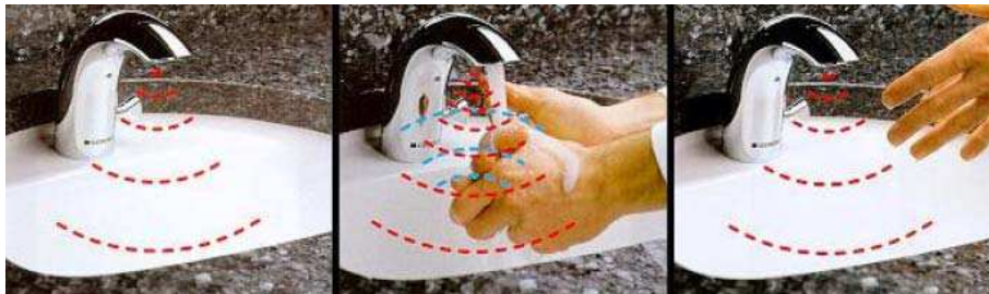
Figura 2.2: Esquema de funcionamento de uma torneira com sensor de presença. Fonte: Gonçalves, 2004.
