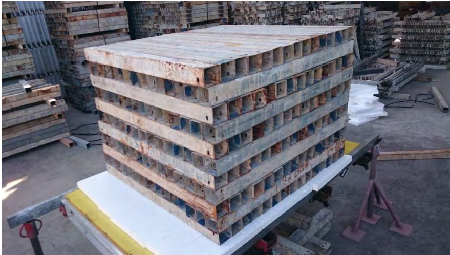
Figura 3: Teste de carga realizado no Plasterit 122 cm x 61 cm.
