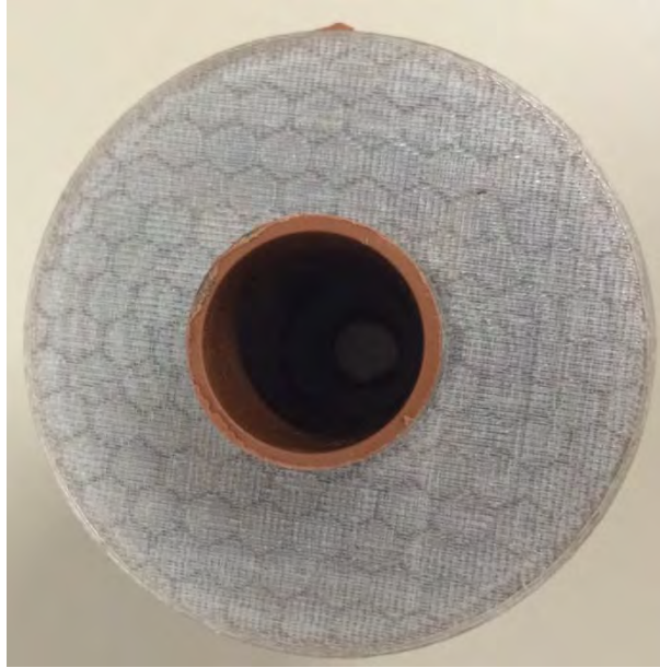
Figura 14: Peça auto-travante desenvolvida para impedir passagem de concreto para dentro do Pocket Former. Modelo feito em impressão 3D.
