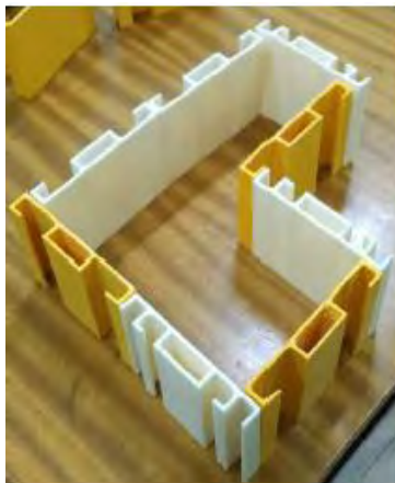
Figura 9: Modelo de impressão 3D das fôrmas de pilares.
