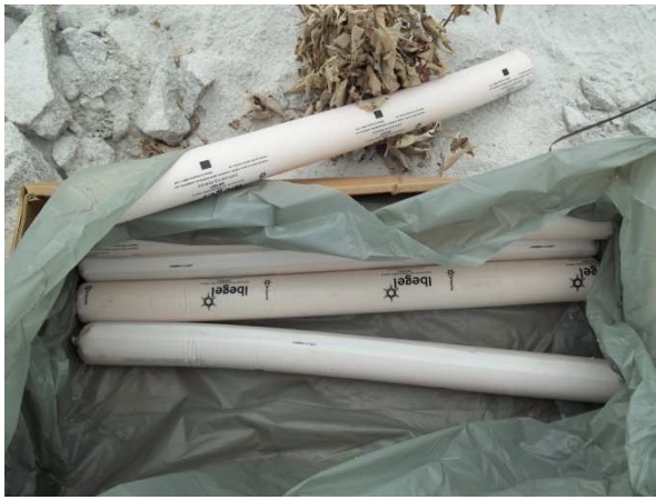
Figura 3 – Explosivos e bancada preparada para detonação
