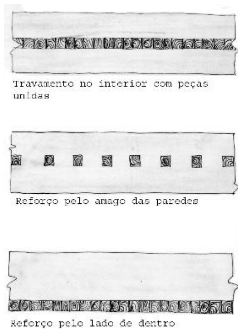
Primeiras fiadas de elevação de parede de taipa de pilão.
