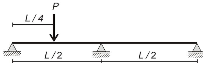
*Observação:* lembrar que uma viga isostática de comprimento  $L$  sem balanços, submetida a uma carga concentrada  $Q$ , de cima para baixo, a uma distância  $a$  do apoio da esquerda ( $0 < a < L$ ) fica submetida a um momento fletor
