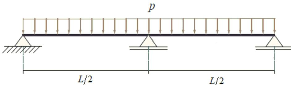
Considerando o carregamento  $p = 35 \text{ kN/m}$ , verifique se o arranjo de armadura detalhado no item **b)** é suficiente para garantir a segurança no ELU. Redimensione a armadura de flexão na seção do apoio interno para a nova solicitação e compare com a armadura detalhada no item **b)**.
