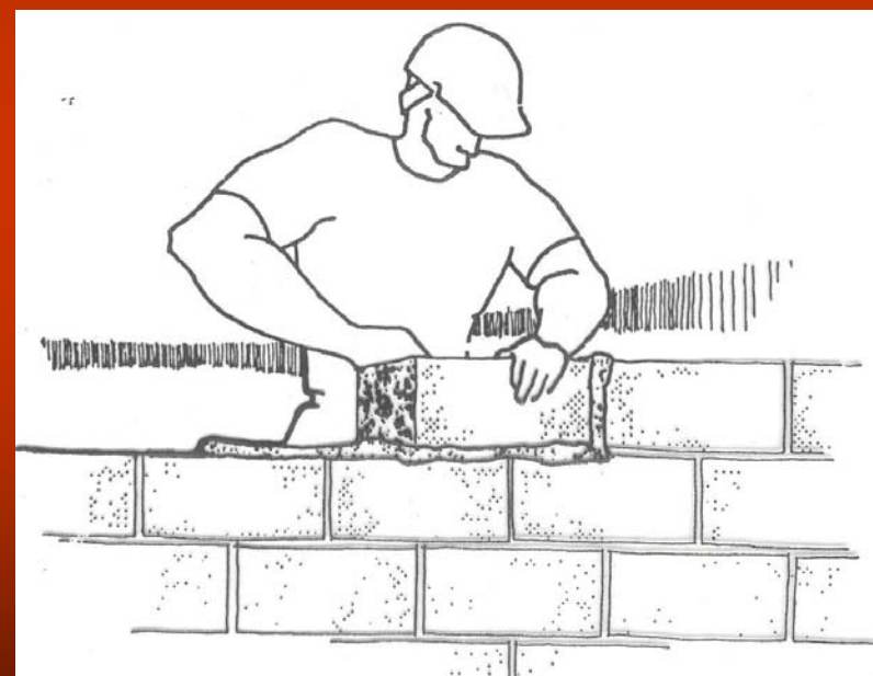
ASSENTAMENTO DE BLOCO
