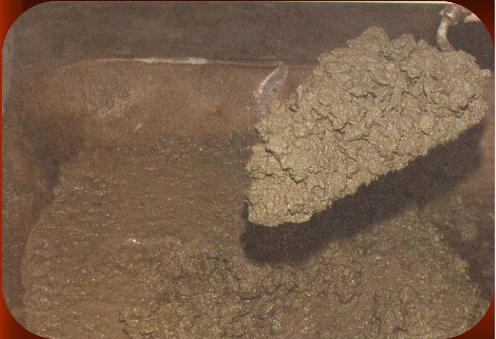
Retirada de amostra (sem desprendimento de agregado graúdo)
