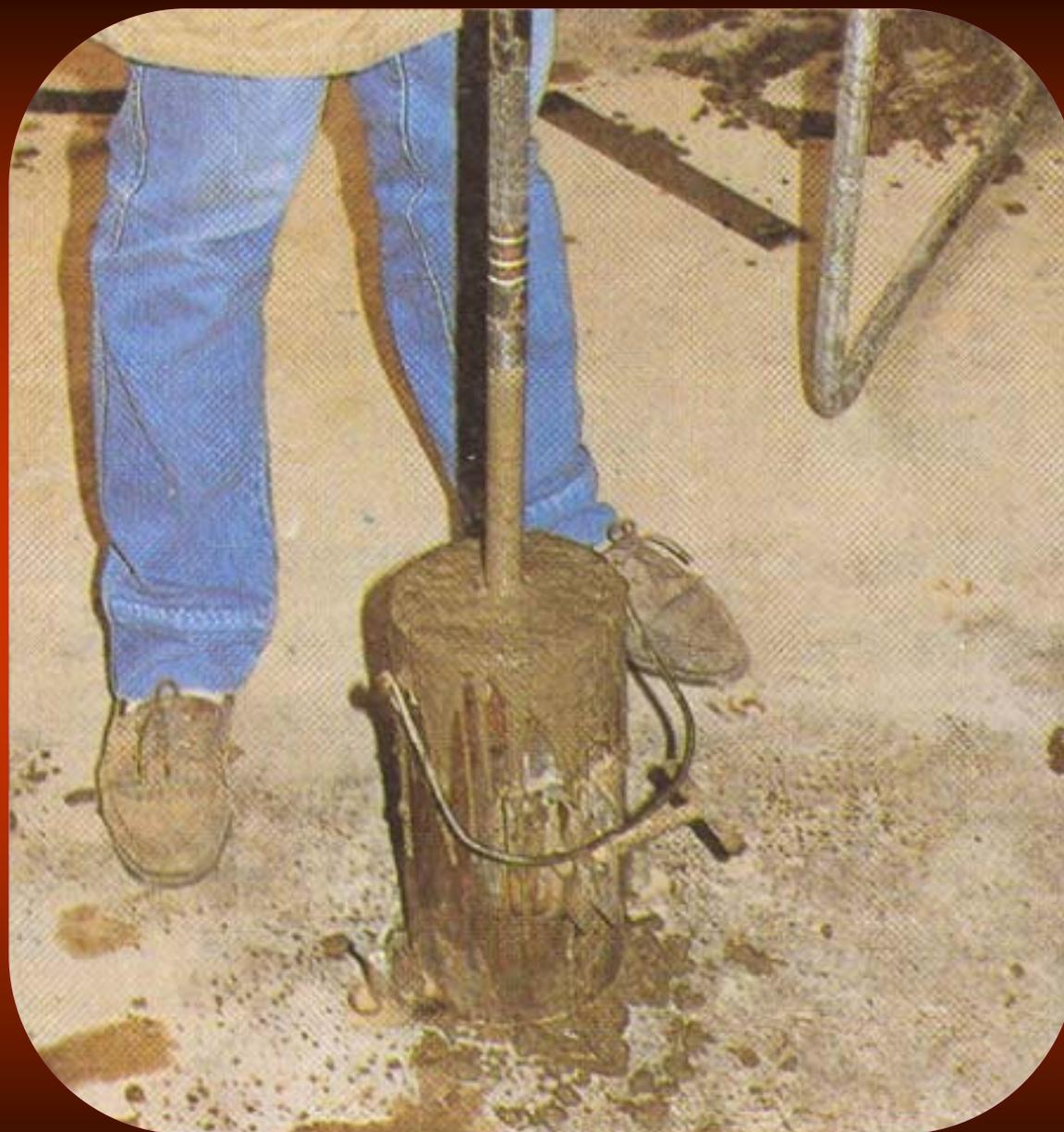
Moldagem de CP para ensaios de resistência à compressão (1 única camada)
