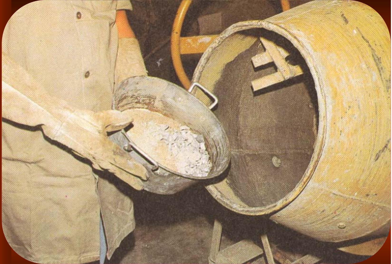
Imprimação da superfície interna da betoneira (~ 6 kg de concreto, traço 1:2:3)
