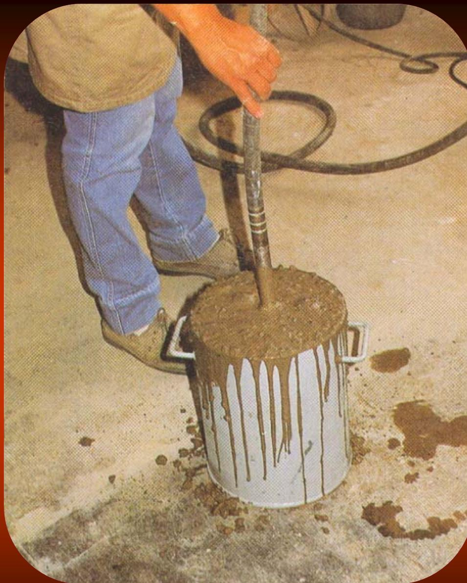
Moldagem para determinação da massa específica no estado fresco (2 camadas)
