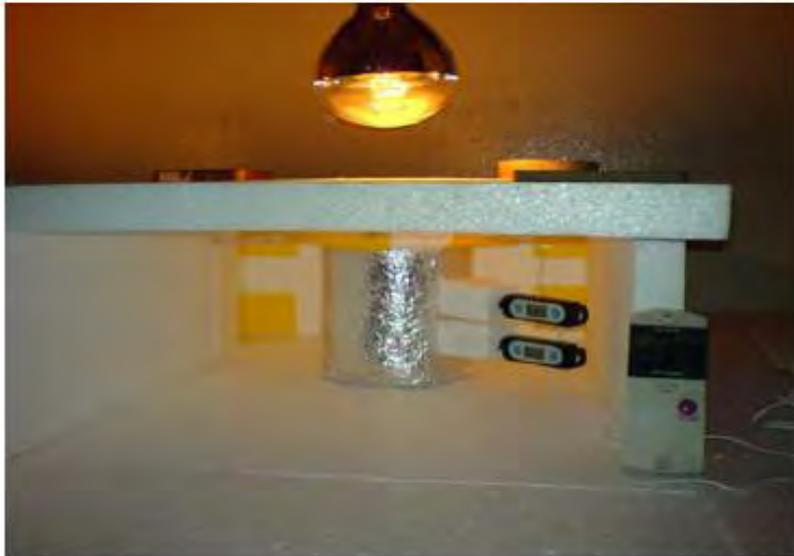
(f) Corpo de prova com termômetros instalados, devidamente posicionado no aparato de ensaio.
