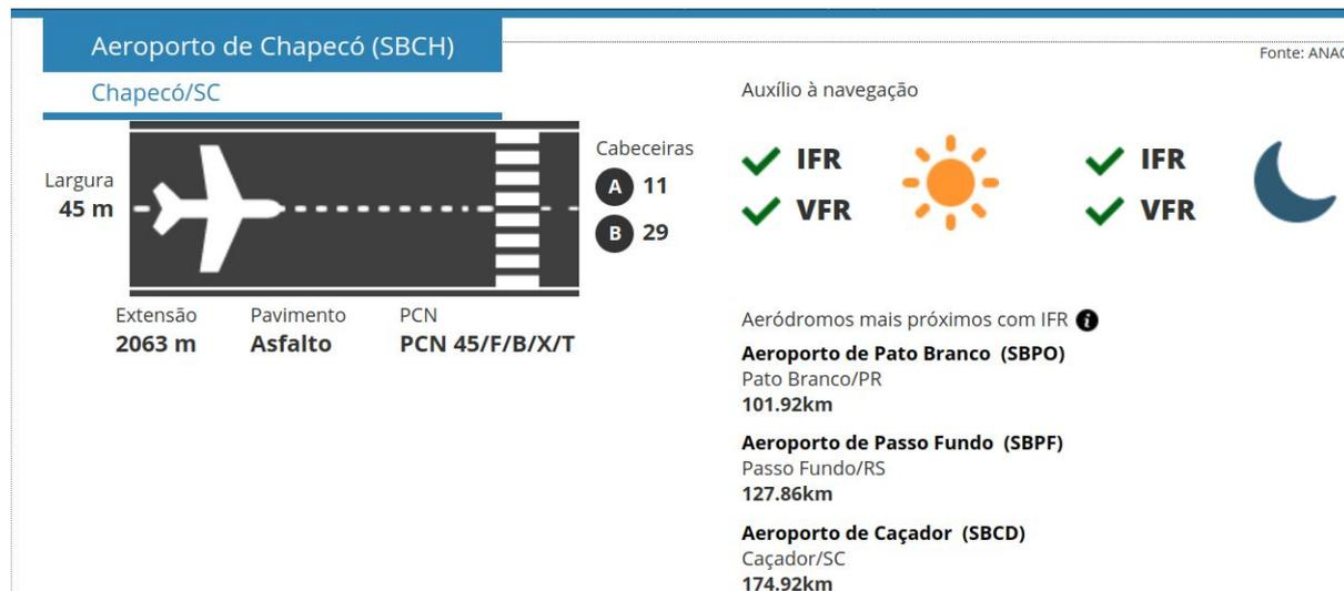
FIGURA 3.3 - Dados técnicos do Aeroporto de SBCH (HORUS<sup>3</sup>, 2020).
