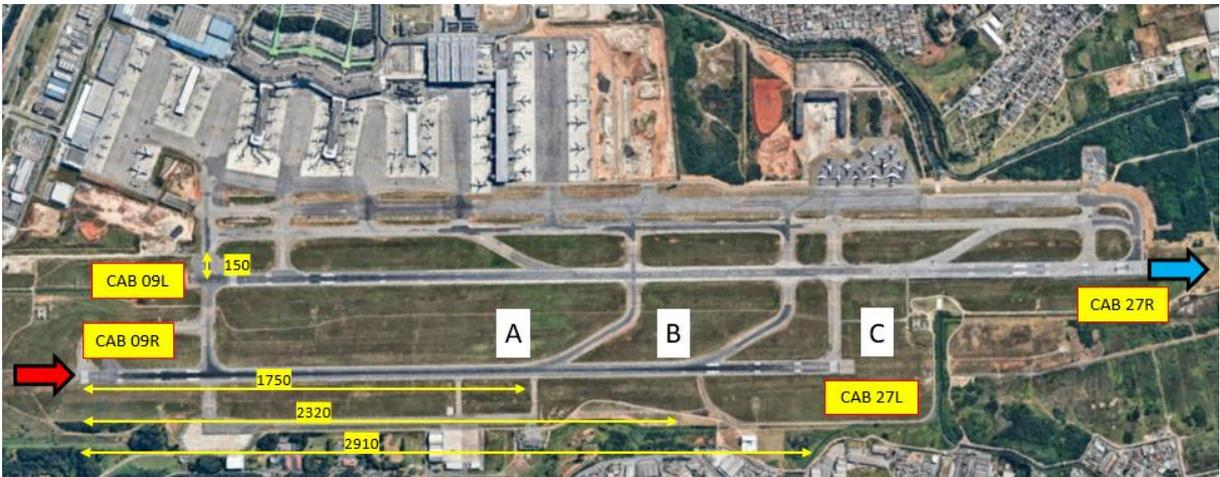
Figura 4.22 - Esquemática das distâncias até cada saída de pista e acesso a cabeceira
