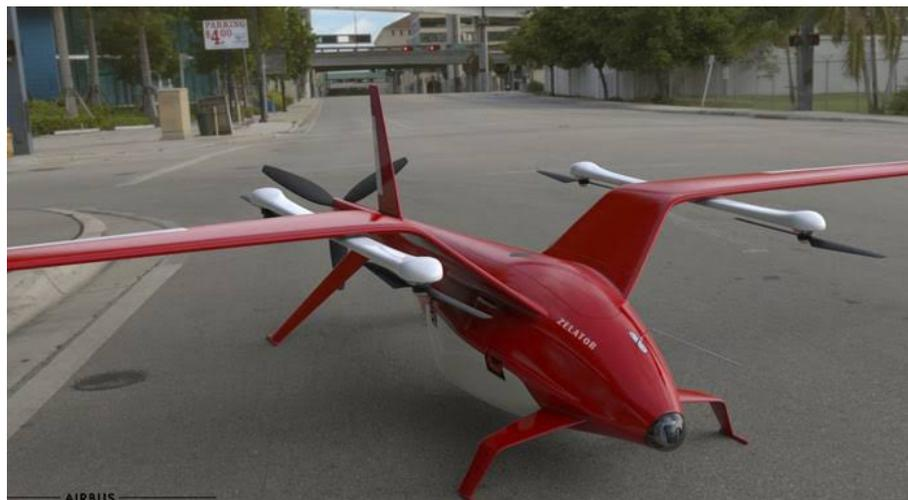
FIGURA 3.3 – Exemplo de RPA Classe 3 com peso superior a 250 g
