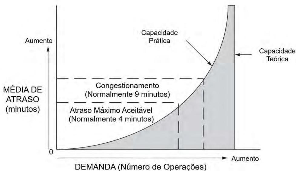
FIGURA 2.1 – Atrasos para decolagem em função do volume de tráfego, (Horonjeff et al, 2010).
