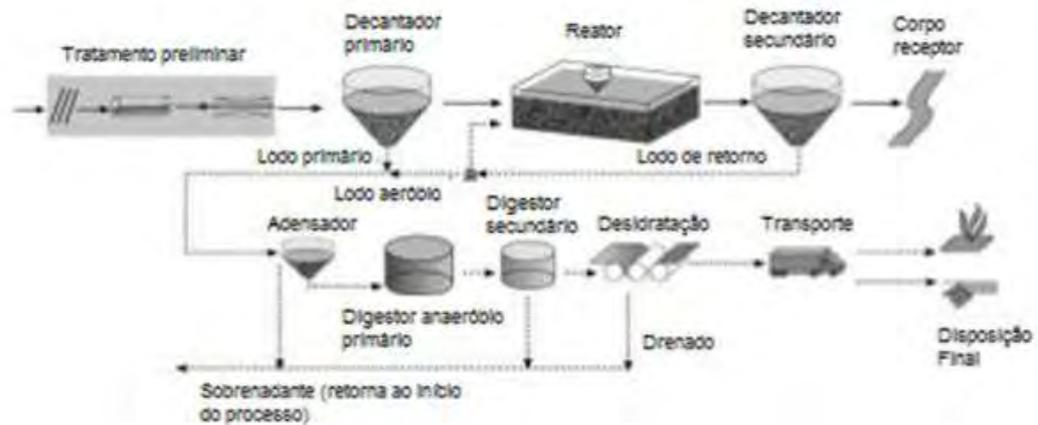
Figura 3 – Fluxograma do sistema de lodos ativados convencional – Adaptado de (VON SPERLING, 2007).
