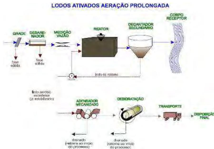
Figura 4 – Fluxograma do sistema de lodos ativados com aeração prolongada – Adaptado de (VON SPERLING, 1996)
