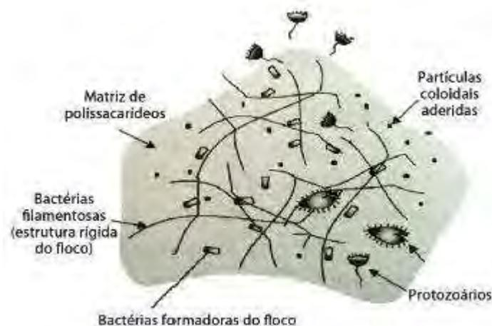
Figura 1 – Estrutura do floco de lodo ativado - Adaptado de (JORDÃO e PESSÔA, 1982).
