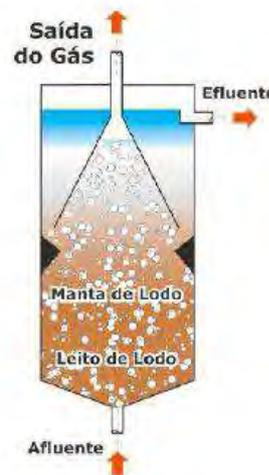
Figura 8 – Esquema simplificado do reator em manta de lodo - Adaptado de (CHERNICHARO, 2008)
