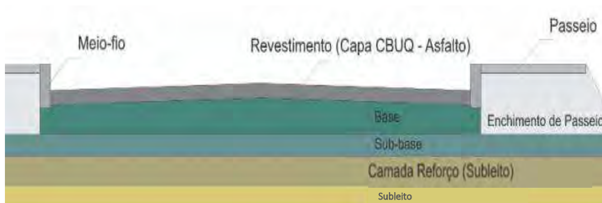
Figura 16. Seção transversal de pavimento flexível - CBUQ
