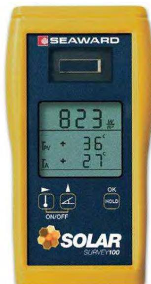
Figura 29. Solarímetro Solar Survey 100/200R
