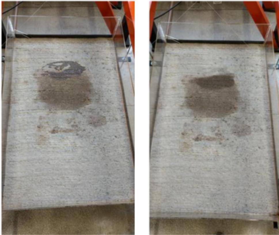
Figura 3.1 – Na esquerda o óleo acabara de ser colocado, e, na direita, o óleo já havia penetrado o concreto.
