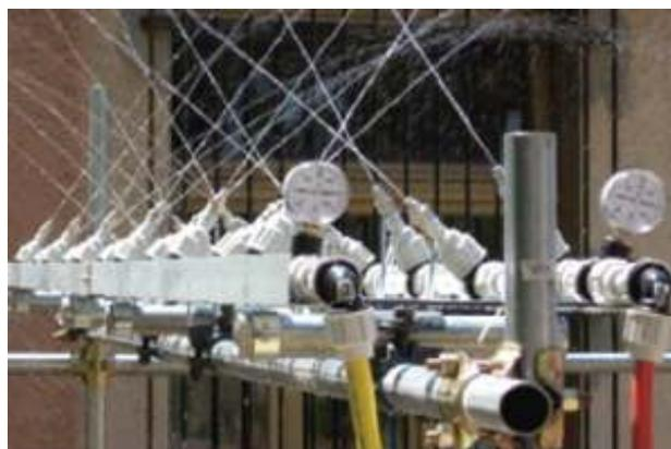
Figura 2.9 – Simulador de chuva por método de bocais pressurizados.
