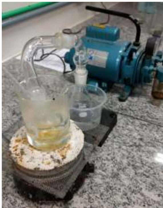
Figura 3.7 – Processo de destilação da solução contendo o óleo da amostra.
