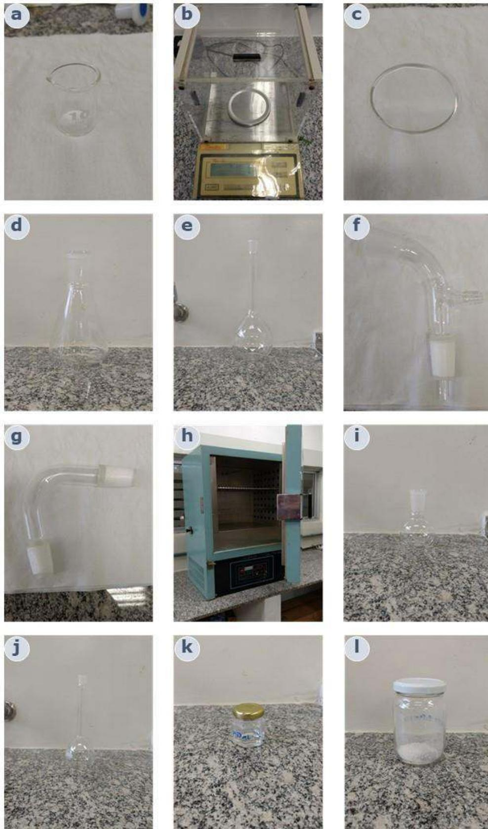
Figura 3.5 – Itens usados na mensuração da concentração de óleo
