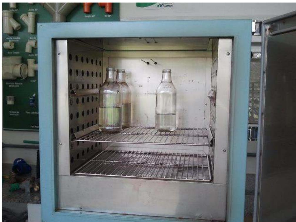
Figura 3.4 – Secagem de amostras na estufa.
