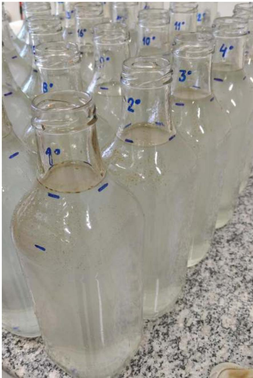
Figura 3.3 – Primeiros litros de amostras com visível contaminação de óleo.
