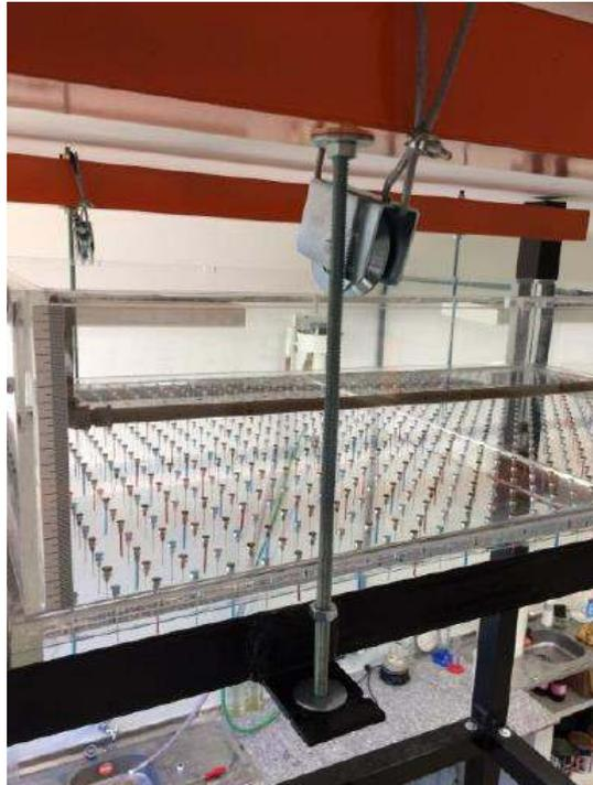
Figura 2.10 - Tanque de gotejamento com parafusos para ajuste de nível e altura.
