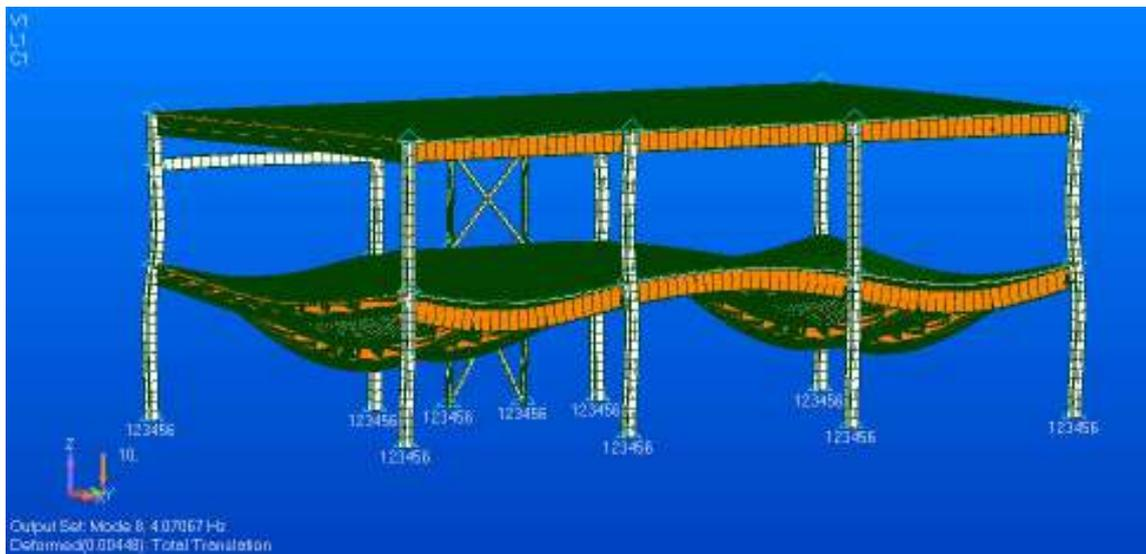
**Figura 5.8** 1º modo de vibração.
