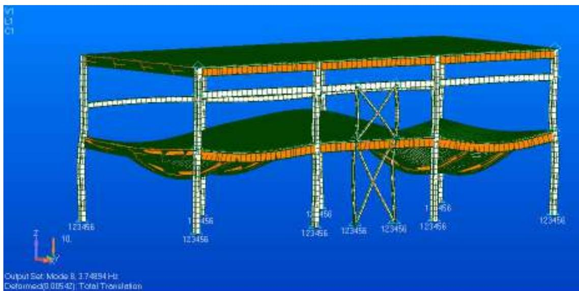
**Figura 5.3** 1° modo de vibração.
