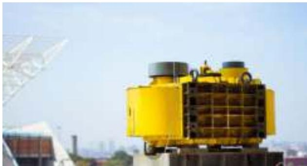
**Figura 2.27** Excitador mecânico (Vibrodina).
