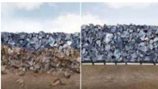
FIGURA 3.1 - Redução de espessura e de resistência pela cravação do material granular no subleito (HUESKER LTDA., 2017).
