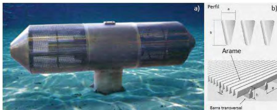
Figura 19: a) Barril em forma de T com arame em forma de cunha realizando a captação offshore. b) Detalhe construtivo e perfil das cunhas que compõe a tela do barril. Fontes: Johnson Screens – adaptadas.
