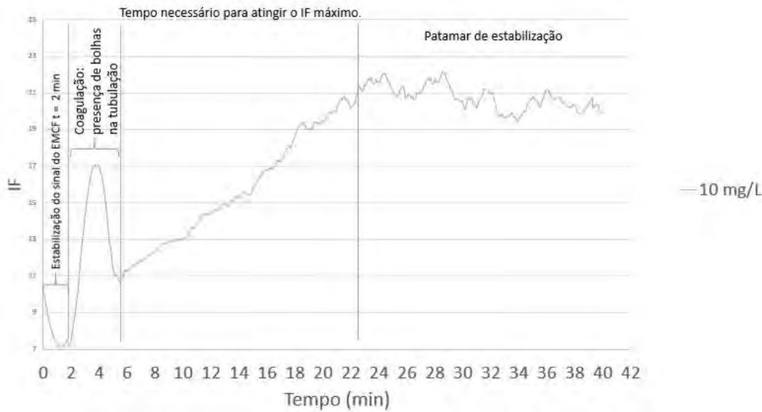
Figura 47: Curva típica obtida no estudo com o destaque das regiões de interesse com a dosagem de 10 mg/L de cloreto férrico como produto comercial (bauminas) na água do mar em pH = 8,0 e temperatura de 21,5 °C.
