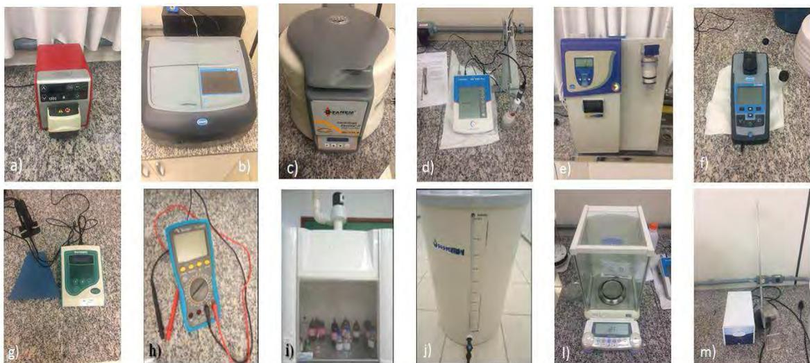
Figura 44: Equipamentos utilizados durante o desenvolvimento dos experimentos. a) Bomba peristáltica; b) Espectrofotômetro; c) Centrífuga; d) pHmetro; e) Ultra purificador de água; f) Turbidímetro; g) Condutivímetro; h) Multímetro digital; i) Capela; j) Barrilete; l) Balança eletrônica; m) Agitador mecânico.
