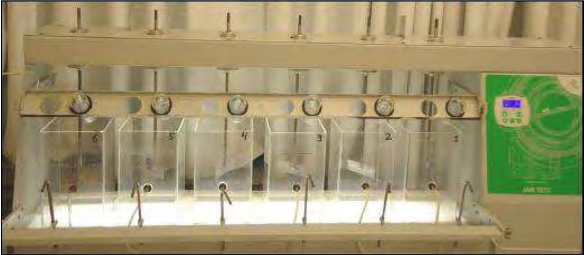
Figura 42: Jartest Ethik utilizado no desenvolvimento da parte experimental.
