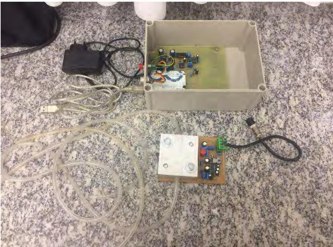
Figura 43: Equipamento de monitoramento contínuo da floculação (EMCF), onde é possível visualizar o micro controlador Arduíno, o corpo do sensor, o tubo Masterflex Tygon 06409-16, a fonte de alimentação e o cabo USB, utilizado para conexão entre o EMCF e o computador.
