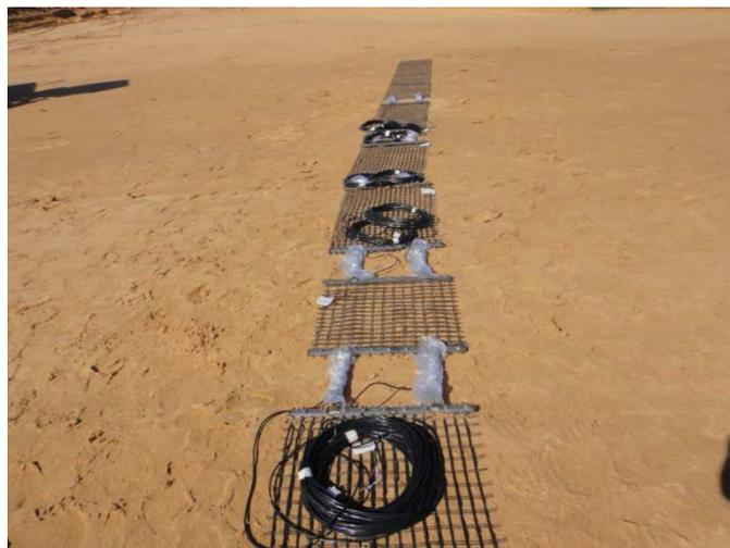
Figura 4.8: Detalhe da seção instrumentada e os cinco pontos onde as células de carga estão posicionadas.
