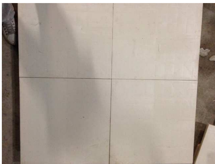
Figura 17 Plasterit com 61 cm e superfície lateral lisa e arestas perpendiculares.
