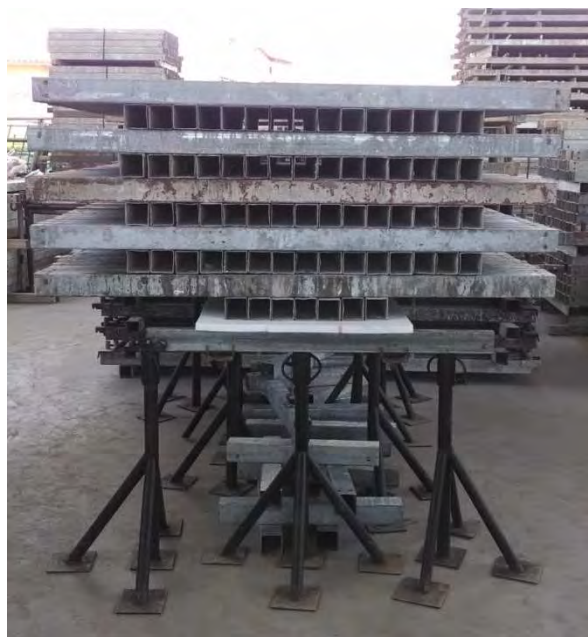
Figura 32 Esquema de simulação de carregamento e medição de deslocamento.
