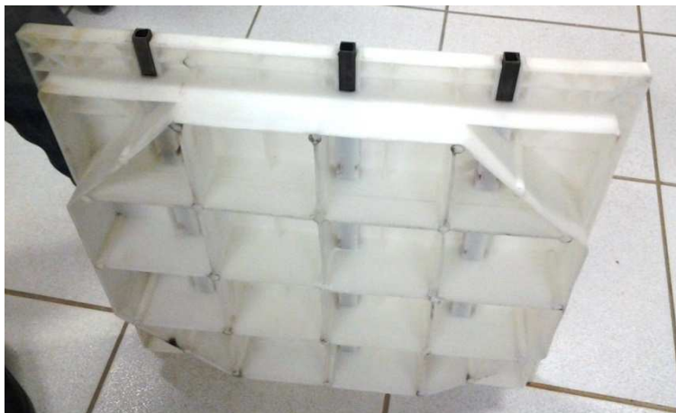
Figura 20 Plasterit reforçado com três barras de aço metalon (fonte: Impacto, 2014).
