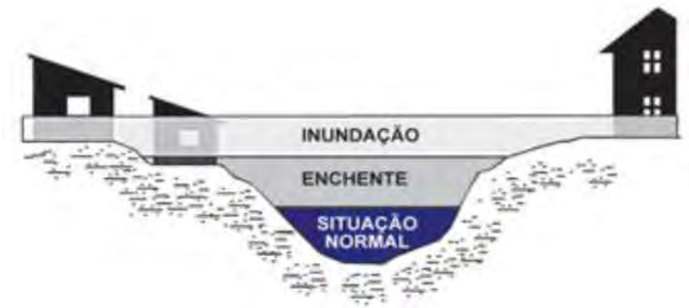
**Figura 3.5 - Perfil esquemático do processo de enchente e inundação. Fonte: IPT, 2007**
