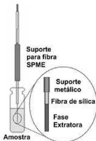
**Figura 15:** Esquema da Microextração em Fase Sólida (SPME). Fonte: Caldas et al., 2011.
