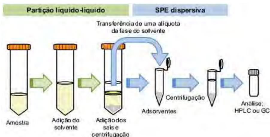
**Figura 17:** Esquema das etapas envolvidas no método de extração QuEChERS. Fonte: Macedo (2012).
