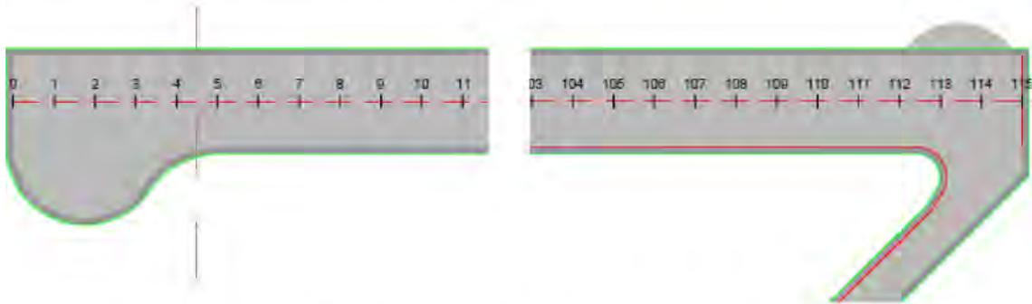
**Figura 6: Exemplo de estaqueamento de uma pista de pouso e decolagem. (ROCHA ENGENHARIA)**
