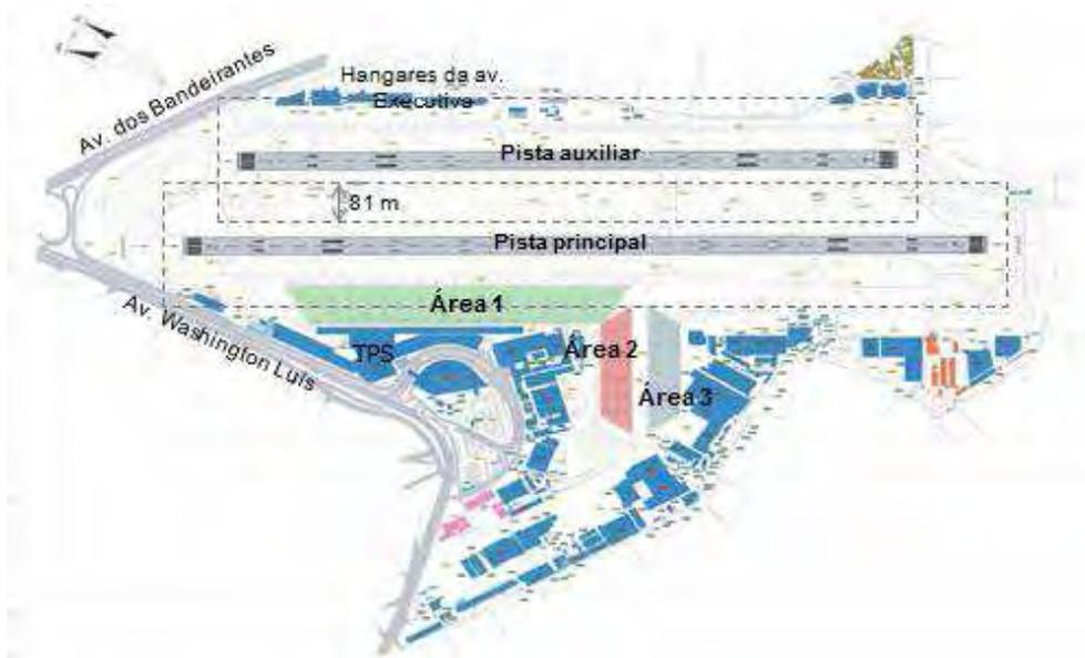
**Figura 20: Planta de Congonhas evidenciando não conformidade de faixas de pista.**
