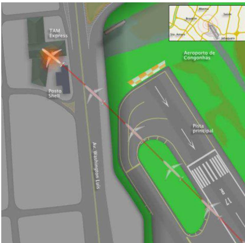
**Figura 5: Esquema da trajetória da aeronave da TAM no momento do acidente (Desastres Aéreos).**
