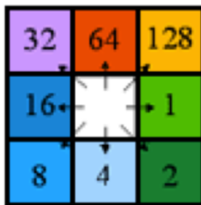
Figura 12 Matriz Direction Code Representação das 8 direções (D8) de modelagem de fluxo proposta por Jenson e Domingue (1988). (ESRI)
