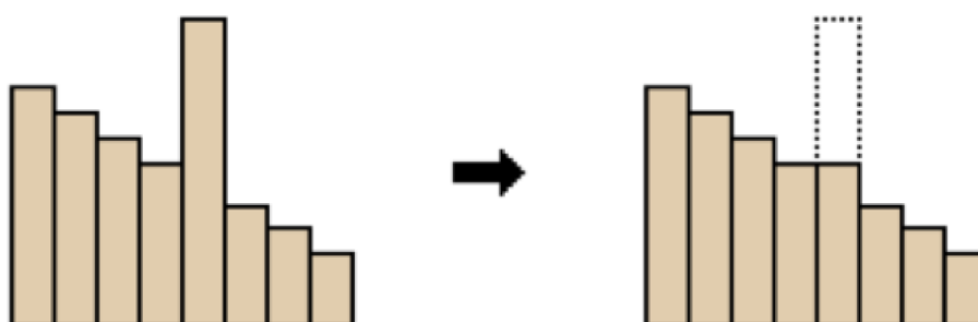
Figura 6 Vista do perfil de um peak e sua correção (ESRI)
