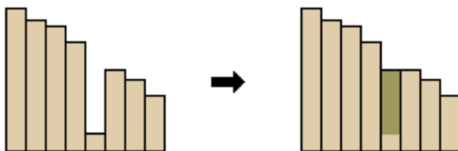
Figura 5 Vista do perfil de um sink e sua correção (ESRI)
