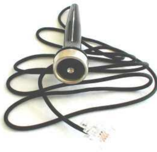
Figura 12 – Dispositivo de transferência de dados do iButton para computador
