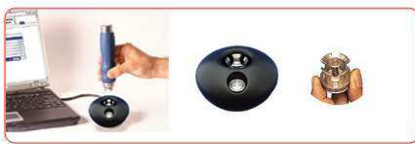
Figura 14 – Esquema de uma base de transmissão de dados com interface USB
