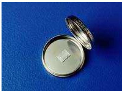
Figura 11 – iButton aberto Fonte: Maximintegrated (2013)
