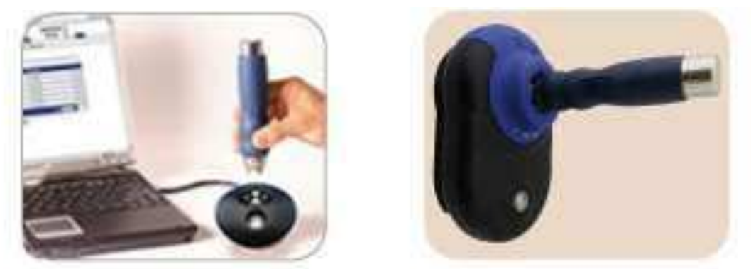
Figura 10 – Exemplos de base de transmissão de dados (à esquerda uma com interface USB e à direita uma com interface GPRS)
