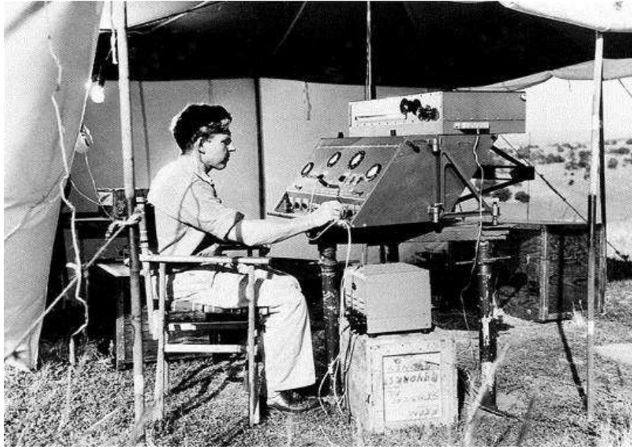
**Figura 1 – Primeiro medidor eletrônico de distância (MED): Geodimeter NASM-2**
