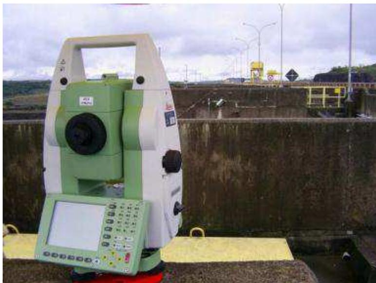
**Figura 3 – Estação total robotizada TCRA1205**
