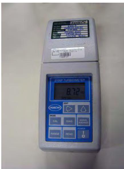
**Figura 19 – Turbidímetro HACH modelo 2100P**
