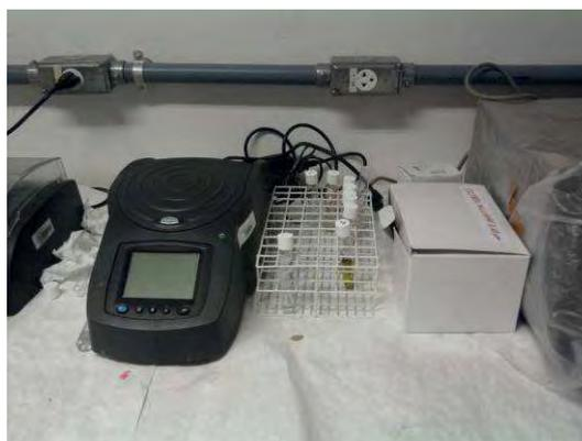
**Figura 20 – Espectrofotômetro HACH**
