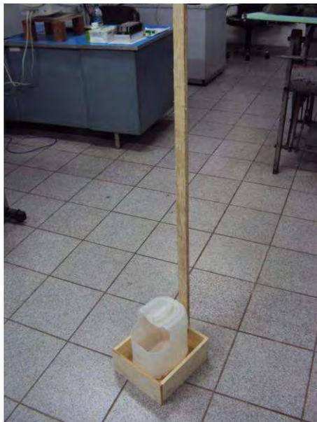
**Figura 17 – Aparato utilizado na coleta de água pluvial**
