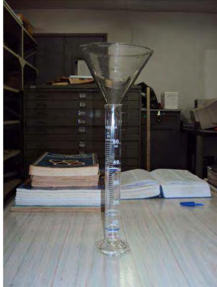
**Figura 16 – Pluviômetro com marcações indicativas do first flush**
