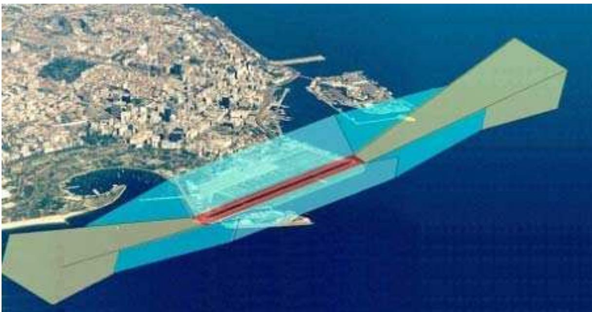
**Figura 3-1** Croqui de um Plano Básico de Zona de Proteção de Aeroportos IAC (2004).
