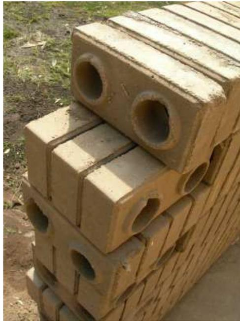
*Figura 8: Tijolos vazados de Terra Compactada perfurados.*
