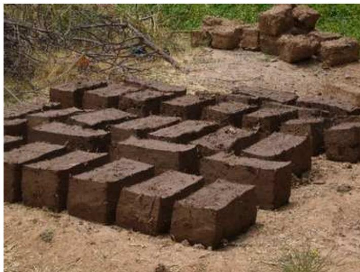
*Figura 9: Tijolos maciços de Terra Compactada perfurados*
