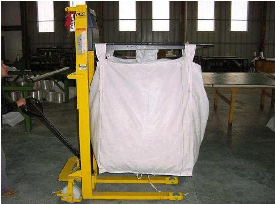
*Figura 7: Imagem de Big Bag sendo transportada no interior de um depósito.*
