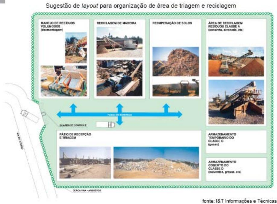
**Figura 12** Sugestão de Layout para organização de área de triagem e reciclagem (Fonte: I&T Informações e Técnicas - Caixa, 2005)
