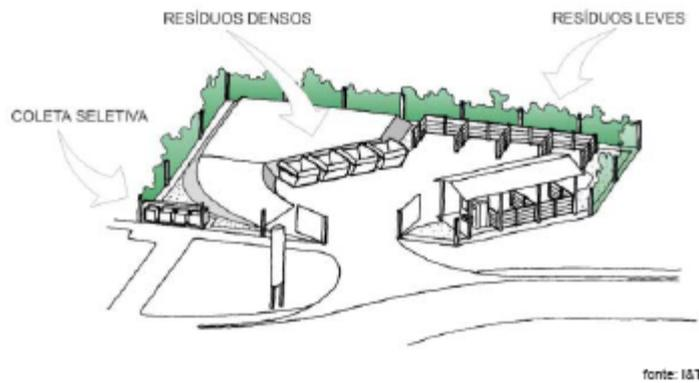
**Figura 9 Proposta de PEV (Fonte: I&T Informações e Técnicas – CAIXA, 2005)**
