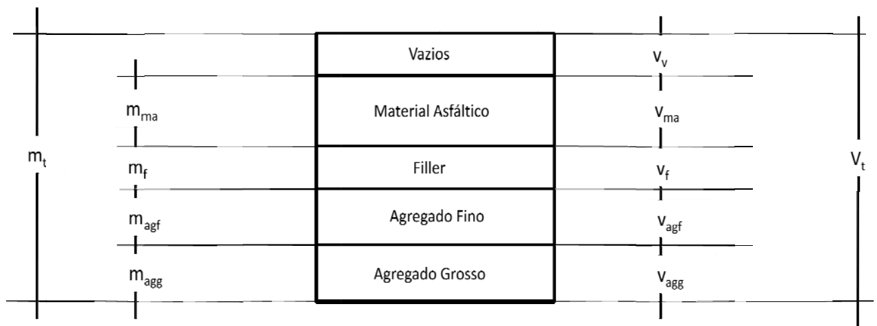
Figura 1 - Constituintes de uma mistura asfáltica
