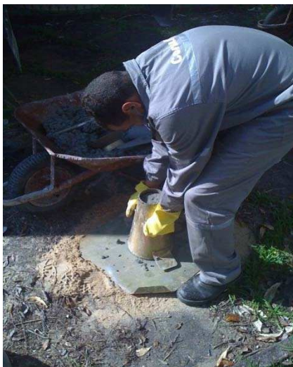
Figura 10 – Desmoldagem do tronco de cone.
