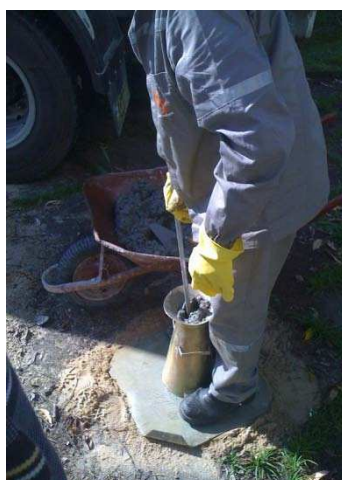
Figura 9 – Adensamento manual por meio de uma haste metálica com 12 golpes/camada
