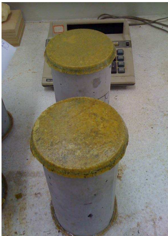
Figura 18 – Capeamento dos corpos-de-prova
