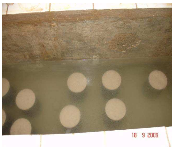
Figura 14 – Cura em tanque com água saturada de cal.
