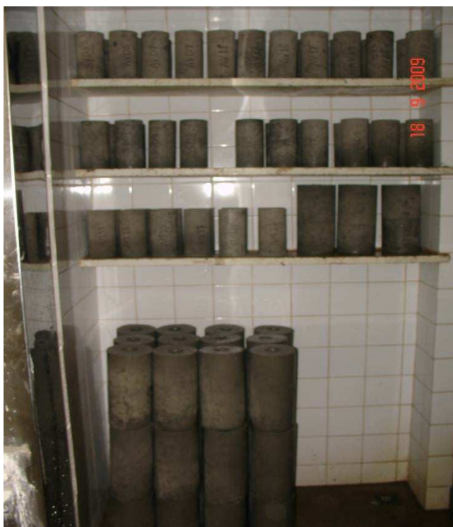
Figura 16 – Cura em câmara úmida
