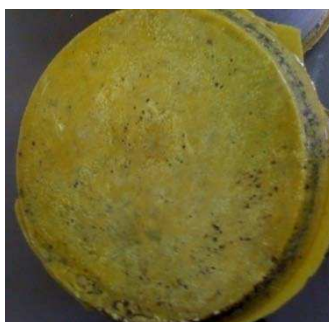
Figura 3 - Corpos-de-prova com a pasta de enxofre nas bases
