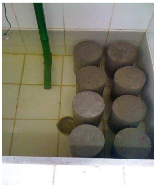
Figura 13 – Cura em tanque com água potável.
