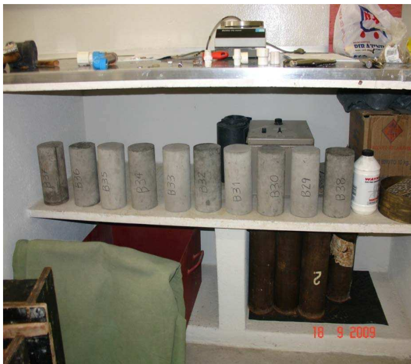
Figura 17 – Cura em ambiente interno ao laboratório
