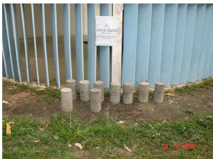
Figura 15 – Cura em ambiente externo ao laboratório
