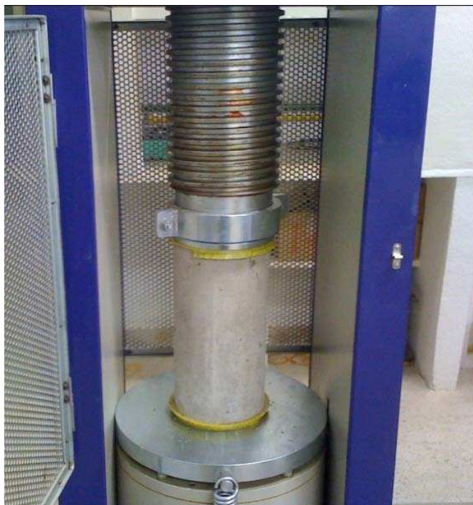
Figura 5 - Ensaio de compressão.
