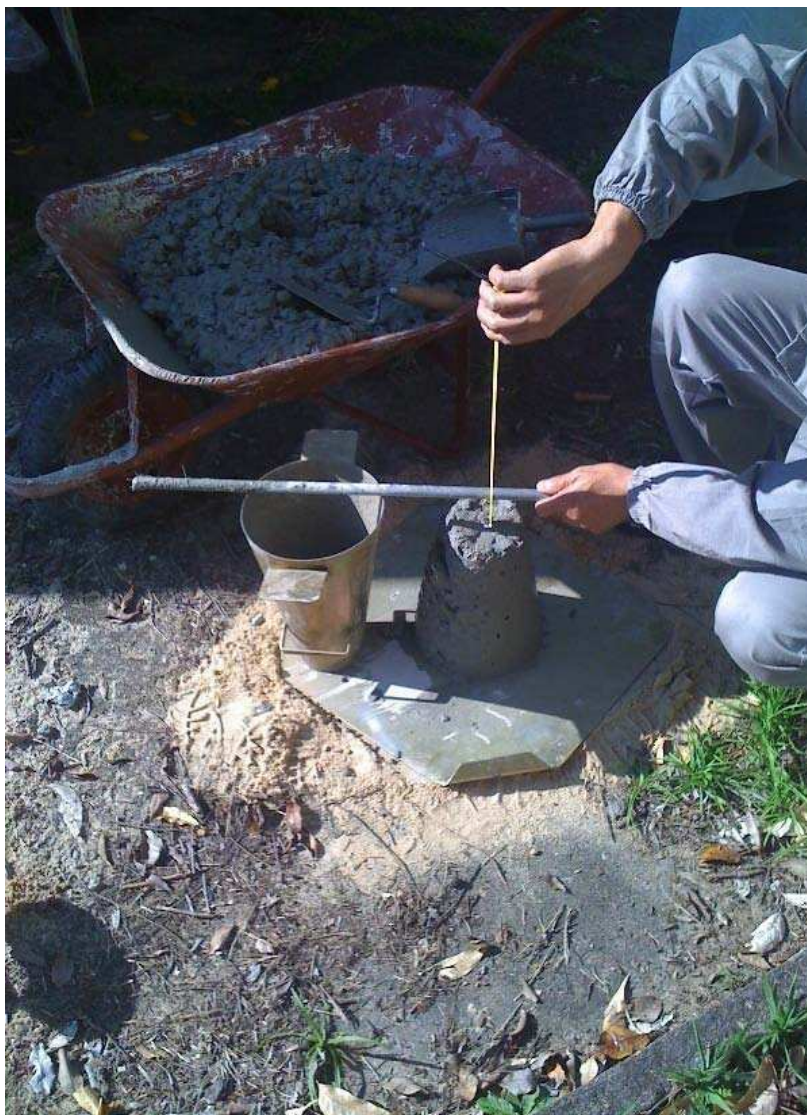
Figura 11 – “Slump Test” de valor 6 cm.
