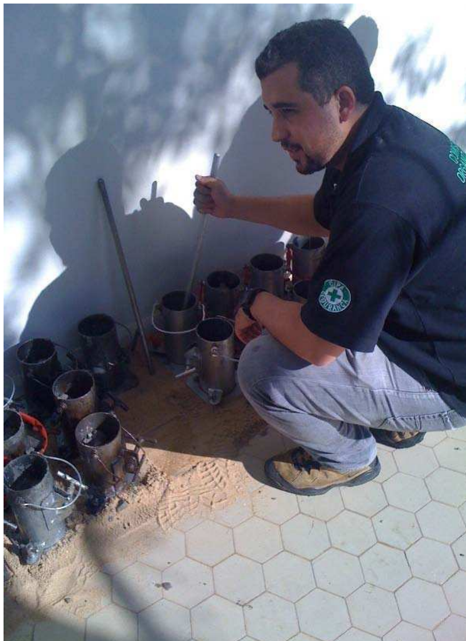
Figura 12 – Moldagem dos corpos-de-prova.
