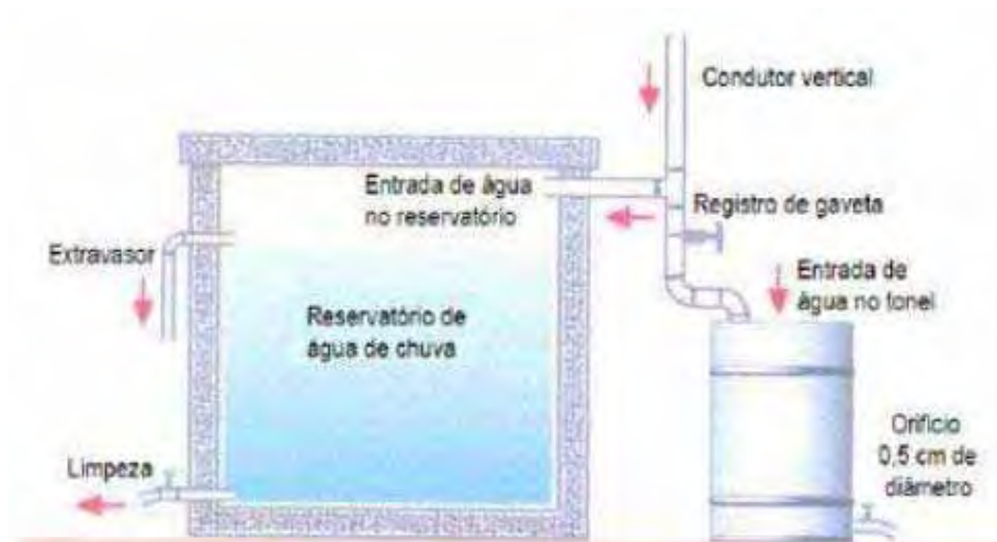
Figura 1: Descarte de primeira água. (Fonte: Dacach, 1990).
