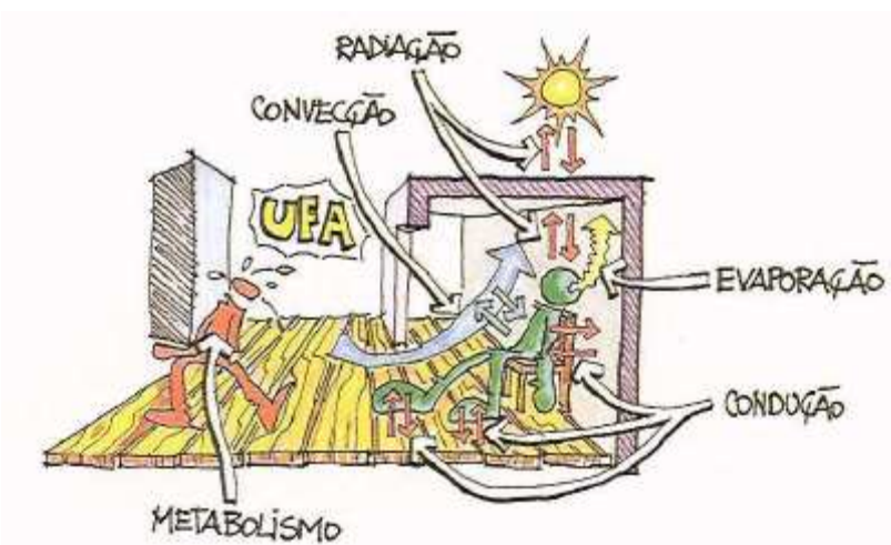
Figura 10 – Representação esquemática das trocas de calor entre o corpo humano e o meio ambiente (LAMBERTS, DUTRA e PEREIRA, 1997)
